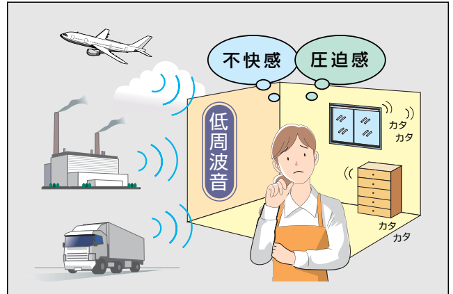
ガタツキを起こしている低周波の例
